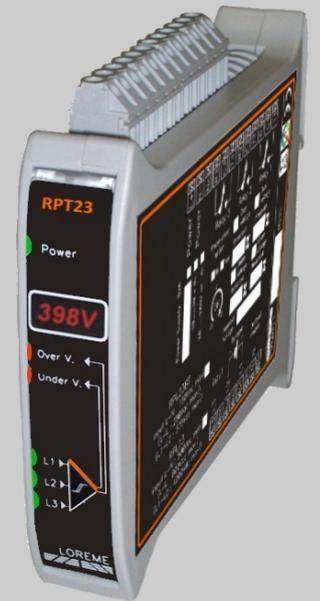
Le relais RPT23 associé, par exemple à un diviseur capacitif, contrôle la présence ou l'absence de tension alternative sur un réseau moyenne ou haute tension. Il peut être utilisé pour la signalisation du changement d'état d'un réseau.
